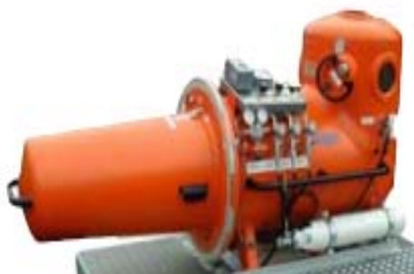
Dvomesna mobilna komora Drager Duocom u koju se smešta i lekar
