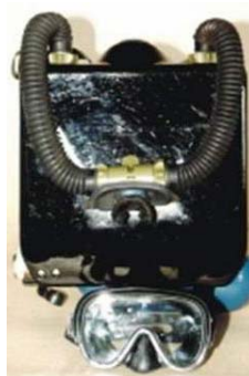
aparat za ronjenje zatvorenog kruga kiseonikom
