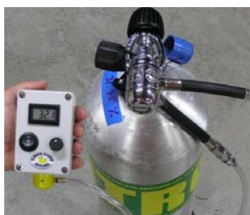
Analizator za proveru procenta kiseonika u smeši
