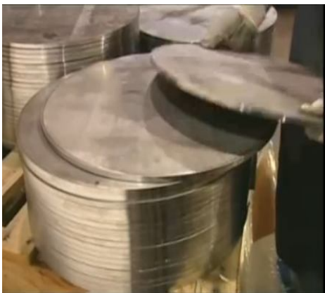
Početak proizvodnje kad se izrađuju od diskova legiranog čelika
