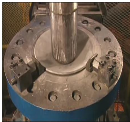
Početak proizvodnje kad se izrađuju od diskova legiranog čelika
